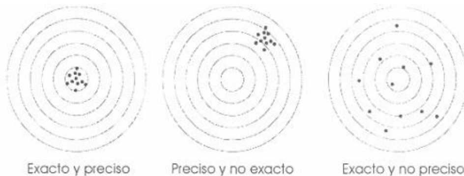
Figura 1. Concepto gráfico sobre exactitud y precisión. Fuente: https://instrumentacionelectronica.wordpress.com/tag/exactitud/
