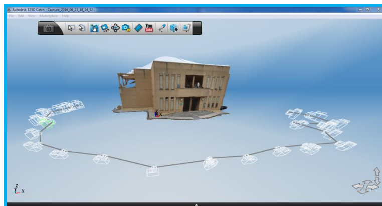
Figura 17. Visión 3D del edificio procesado con 123D Catch.
