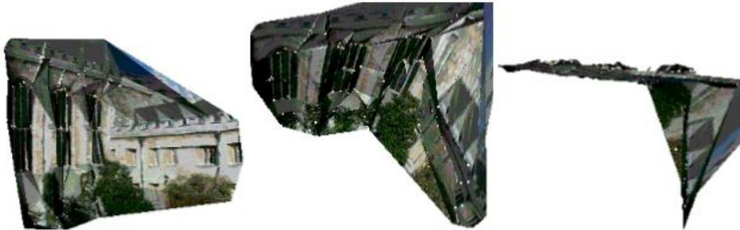
Figura 4 Reconstrucción obtenida únicamente a partir de puntos triangulados. Los puntos están unidos por caras triangulares mapeadas con textura, obtenidas usando triangulación Delaunay. Esta reconstrucción es bastante ruidosa.
