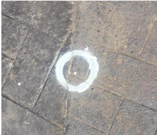
Figura 19. Punto de estacionamiento del receptor fijo
