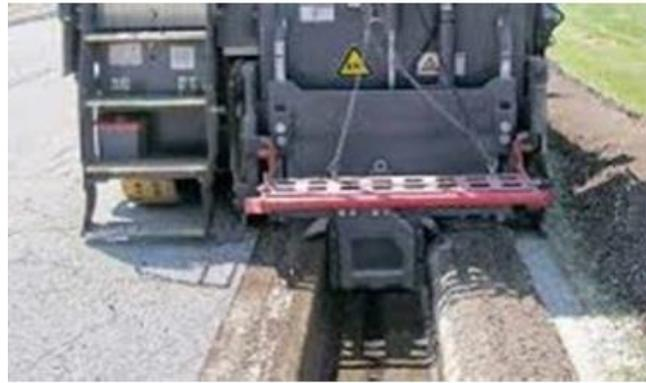
Figura 22. Zanjadora especializada en cunetas
