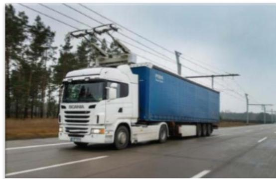
Figura 9. Soluciones de pantógrafo con este sistema
