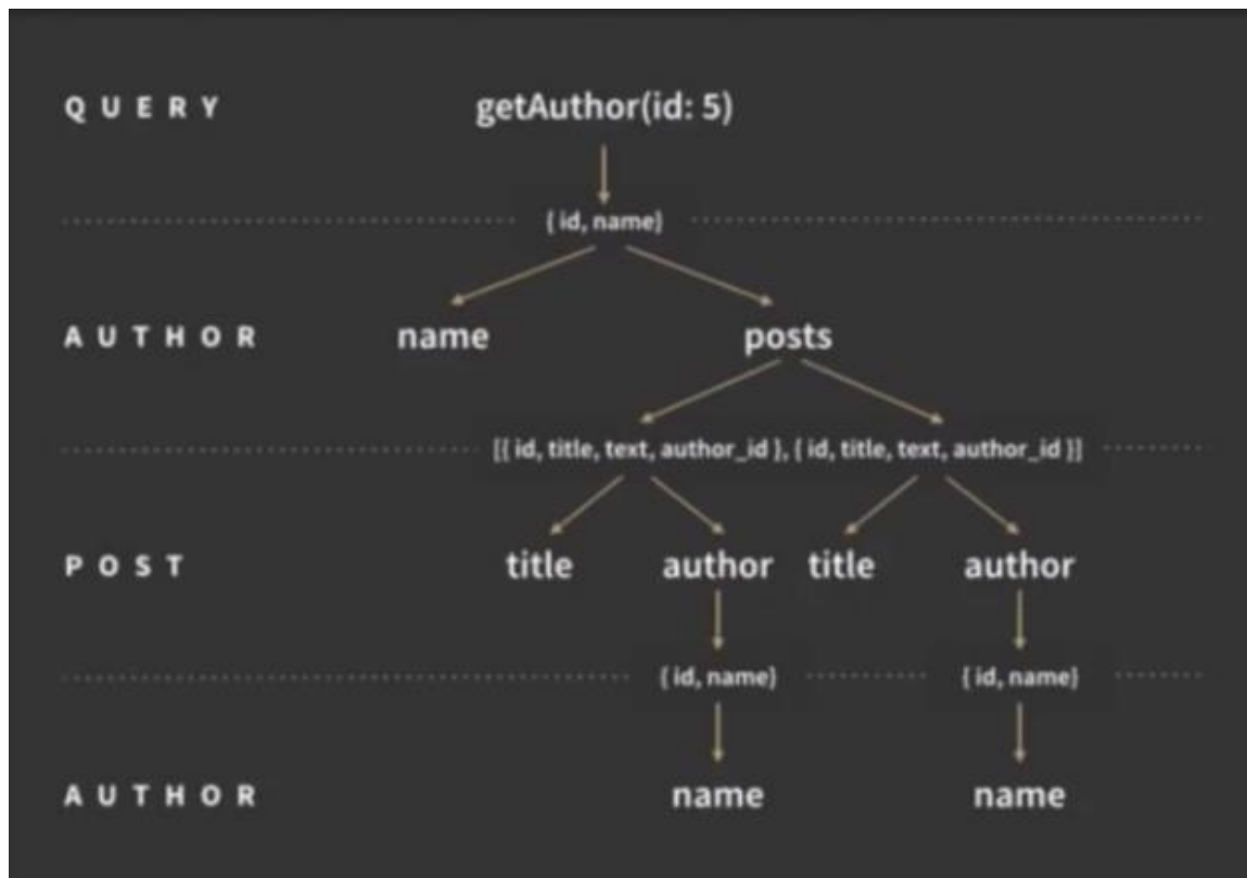
Ilustración 12 Estructura de Datos en GraphQL
