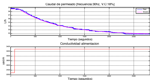
Figura 4: Respuesta del caudal de permeado frente a un cambio de la CE del agua de alimentación.
