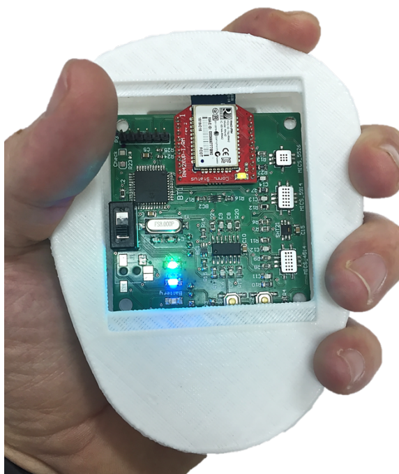
Figura 2: Prototipo de la nariz electrónica
