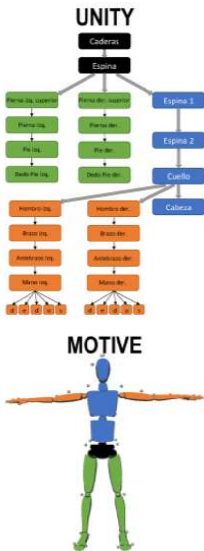
Figura 5: Correspondencia, representada con colores, entre la jerarquía del esqueleto del avatar de Unity y el esqueleto de Motive
