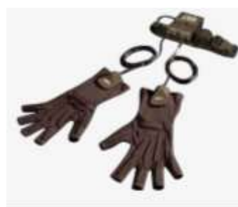
Figura 6: Guantes de datos con 5 sensores de flexión
