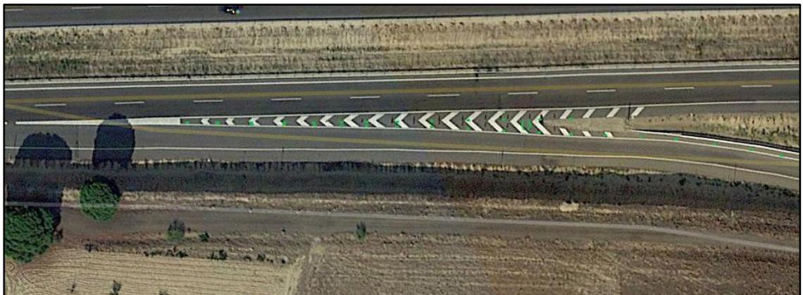
Figura 4.3.36.- (Google-Propia). Situación propuesta: la primera baliza cilíndrica avanza 76 m con respecto al primer hito de vértice posible.
