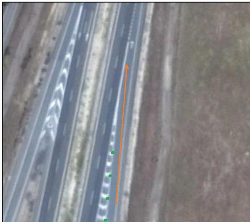
*Figura 4.3.27.- (Google-Propia). Prolongación visual de línea blanca de arcén imposible de cumplir con las balizas cilíndricas, pues se condicionaría el tránsito de ciclistas.*
