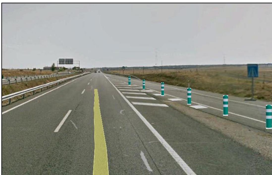
*Figura 4.3.33.- (Google-Propia). Prolongación visual de línea blanca de arcén imposible de cumplir con las balizas cilíndricas, pues se condicionaría el tránsito de ciclistas.*
