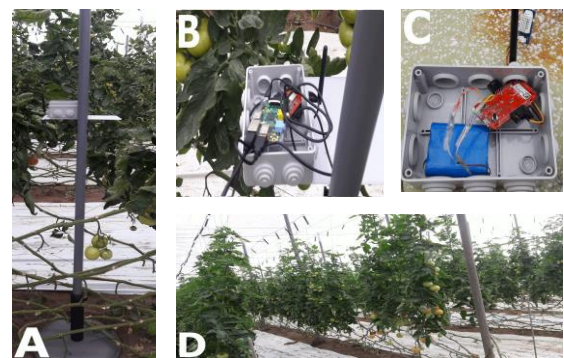
Fig. 3. A) Ubicación de nodo transmisor en el interior del invernadero, B) Nodo receptor conectado al computador embebido Raspberry Pi, C) Nodo transmisor alimentado por batería Lítio-Ion de 3.7 V – 6600 mAh, D) Vista interna del invernadero de Tomate.
