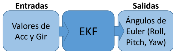
Figura 3: Proceso de estimación de los ángulos de Euler utilizando un EKF.
